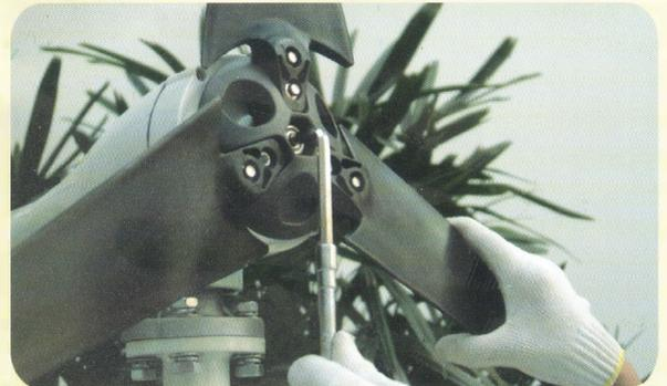
6. Inserte la tuerca en el orificio hexagonal en el centro para fijar el hub al aerogenerador, atornille con la llave de mano izquierda y la derecha gire el hub a la misma velocidad/fuerza para ajustar.
